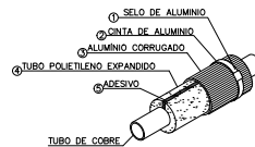
DETALHE 02 Sem Esc | Isolamento da tubulação exposta
