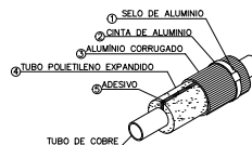
DETALHE 06 Sem Esc | Isolamento da tubulação exposta
