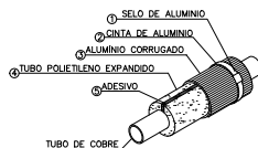
DETALHE 05 Sem Esc | Isolamento da tubulação exposta
